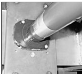
Рис.3.2 Крепление двигателей "Somfy" серий LT 50 NHK и LT 60 NHK.
